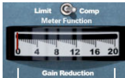
コンプレッサ/リミッタ/サイドチェーン・バージョンのゲインリダクションメーター
